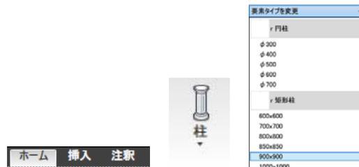
②右図のように、通り芯の交点に柱を配置します。
