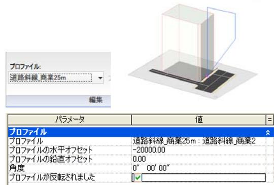
③道路境界線から 20m の距離をとるためにプロファイルを移動します。また、挿入されたプロファイル形状が反転しているのを修正します。
